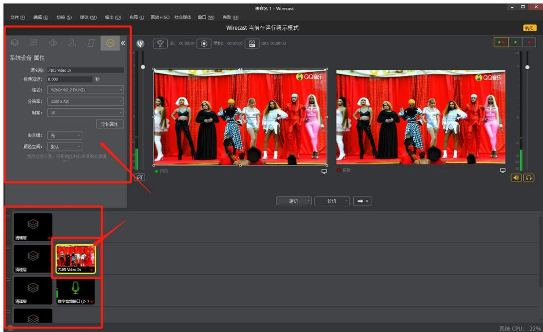
注意：wirecast 采集 HDS7105 视频，视频格式只支持 YUV，分辨率最高支持 1280X720。
